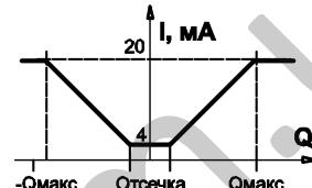
Рис. 5 – Выходная характеристика токового выхода ПРЭМ
