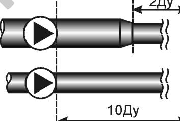
**Прямой участок** – прямолинейный отрезок трубопровода, не содержащий местных гидравлических сопротивлений (сужения, расширения, задвижки, клапаны, термопреобразователи и др.).
