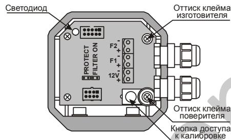
Рис. 3 – Места пломбирования
