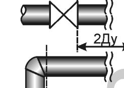
Отвод, колено, полностью открытая задвижка (за исключением шаровой), гильза термопреобразователя
